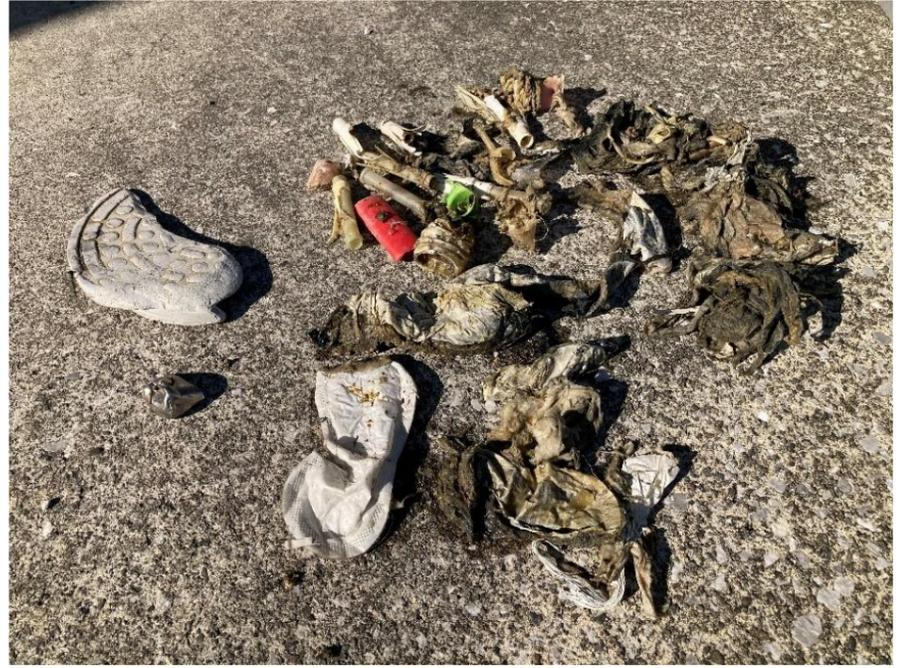
↑ 12月の機器トラブルでは生理用品、ライター、桝のフタ等が流れてきたことにより、ポンプが動作不良を起こしています。
