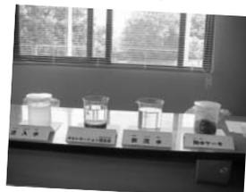
左から、1. 流入水 2. 微生物が分解した水 3. 放流水 4. 脱水した汚泥
